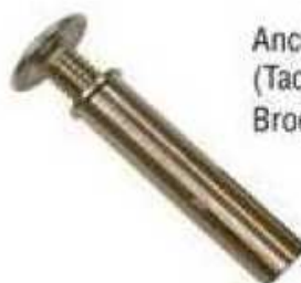
Anclaje escamoteable de dos piezas (Taco latón y tornillo inoxidable). Broca de 10 mm Ø.
