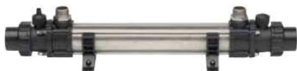
El intercambiador de calor se instala en el circuito de filtración de la piscina, desde el cual el agua pasa en los tubos de titanio del intercambiador. El agua del circuito de calentamiento primario fluye a contra-corriente a través el exterior del tubo y calienta el agua de esa manera.
